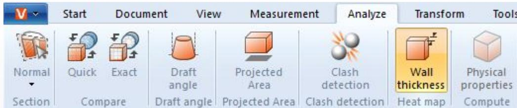
与壁厚测量（[测量](#)〔33〕选项卡）不同，进行壁厚热力型数据地图分析时会对某个选定项的整个表面进行着色。壁厚对应的颜色请参见模型区右侧边缘处的色标。
