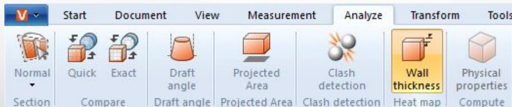
与壁厚测量(测量<sup>35</sup>选项卡)不同, 进行壁厚热力型数据地图分析时会对某个选定项的整个表面进行着色。壁厚对应的颜色请参见模型区右侧边缘处的色标。
