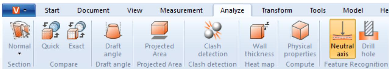
这种柱状或管状截面的纤维或层被称为中性纤维(轴线)，其长度在扭转或弯曲时不会改变。使用此工具可确定圆管拉伸的长度，与弯曲度无关。正因如此，该功能有时也被称为“拉伸长度计算器”。基于各个段计算中性纤维。一个段被构建为两个圆周，通过一条直线连接或一个弧构建。
