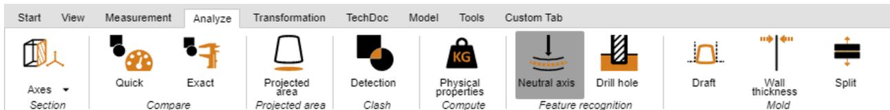
Une fibre neutre (ligne zéro) est la fibre ou la couche d'une section transversale de barre ou de tube dont la longueur ne change pas avec la torsion ou la flexion. Cet outil permet de déterminer la longueur étirée des tubes circulaires, indépendamment de leur cintrage. La fibre neutre est calculée sur la base de segments individuels. Un segment est formé de deux cercles reliés par une ligne droite ou formant un arc de cercle.
