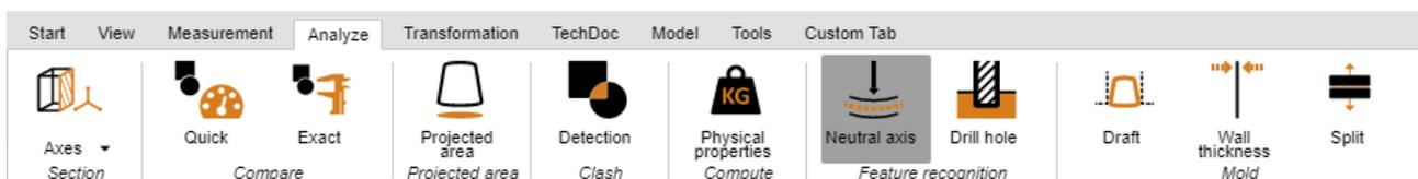
Une fibre neutre (ligne zéro) est la fibre ou la couche d'une section transversale de barre ou de tube dont la longueur ne change pas avec la torsion ou la flexion. Cet outil permet de déterminer la longueur étirée des tubes circulaires, indépendamment de leur cintrage. La fibre neutre est calculée sur la base de segments individuels. Un segment est formé de deux cercles reliés par une ligne droite ou formant un arc de cercle.
